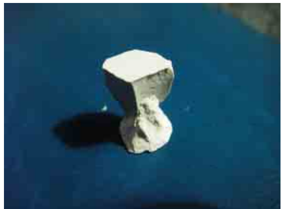
Образец биоцемента после механических испытаний
