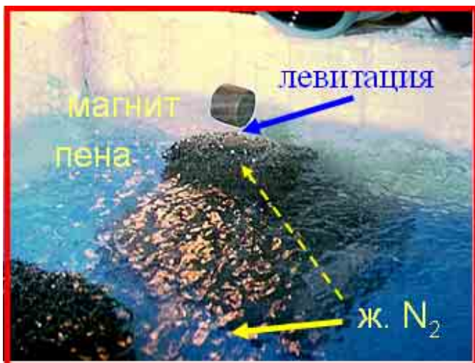
Левитация магнита над охлаждаемой жидким азотом пенокерамикой ВТСП.
